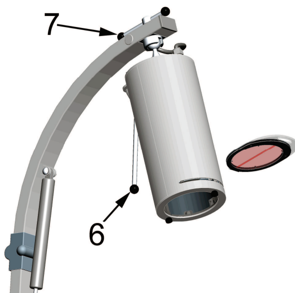
Rysunek 6 – Miejsce wsuwania filtrów.
